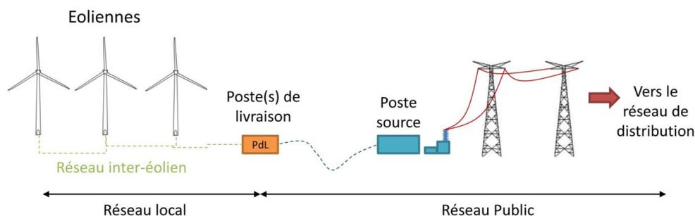
Figure 8 : Raccordement électrique des installations
