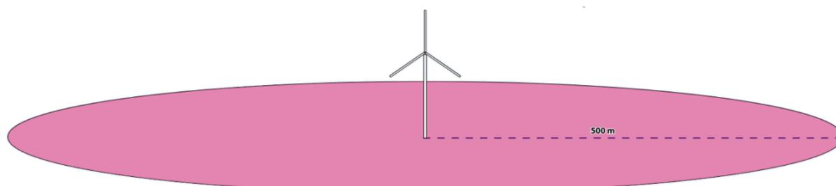
**Figure 14 : zone d'effet / projection de pales ou de fragments de pale**
