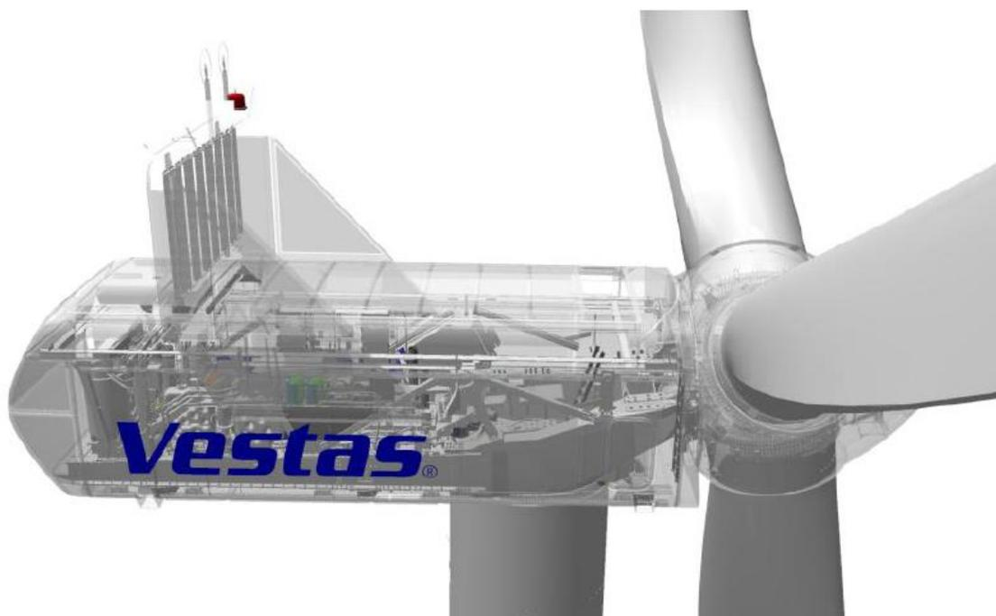
Figure 7 : Illustration de la nacelle (Source : Vestas)
