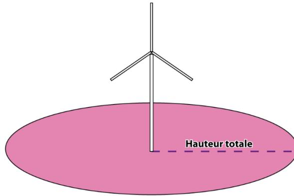
Figure 11 : zone d'effet / Effondrement de l'éolienne
